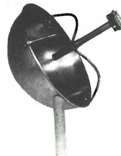
Fig. 4 - Negli esperimenti di conversione in suoni dei raggi di luce provenienti dalle grandi distanze (sole, luna, fari marittimi, ecc.), la cellula solare deve essere sistemata nel fuoco di un paraboloide.
